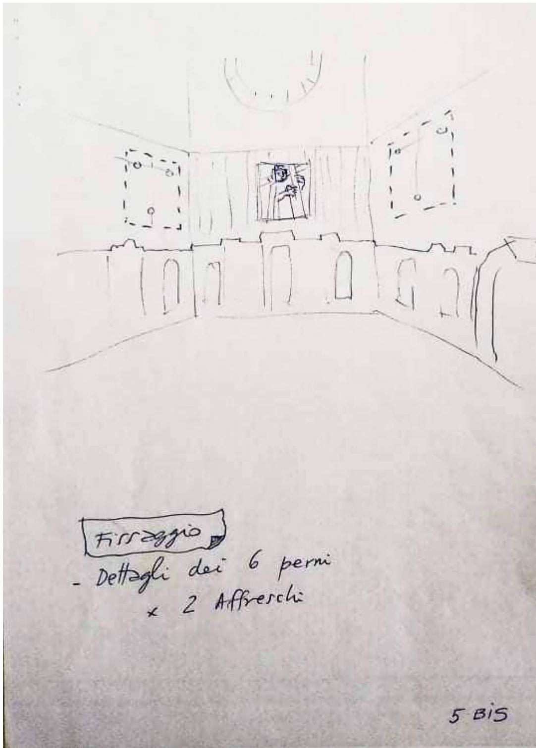
*Dettagli delle 6 viti o perni (installati nelle pareti mediante tasselli) che supportano i 2 pannelli (3 viti per pannello)*
